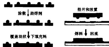
图12 圆片级可返工助焊剂下填充工艺过程
